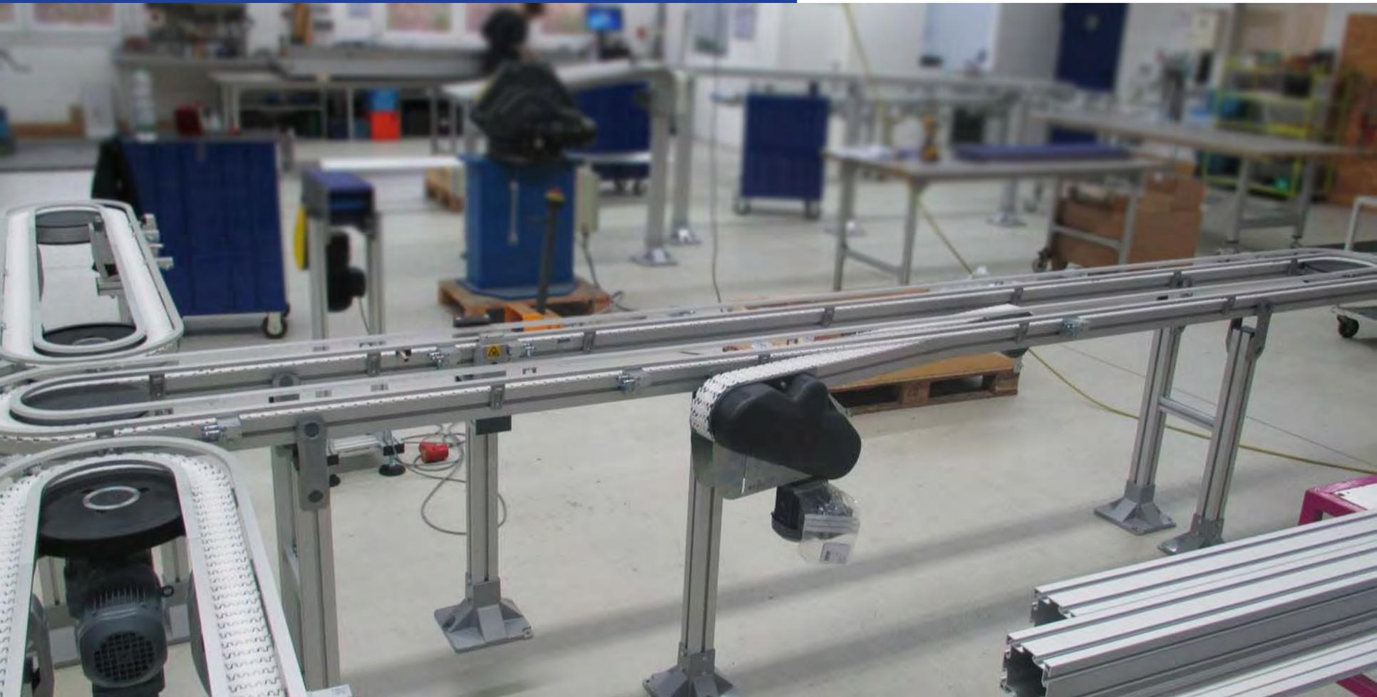
Transport von Kleinteilen mit Werkstückträger
