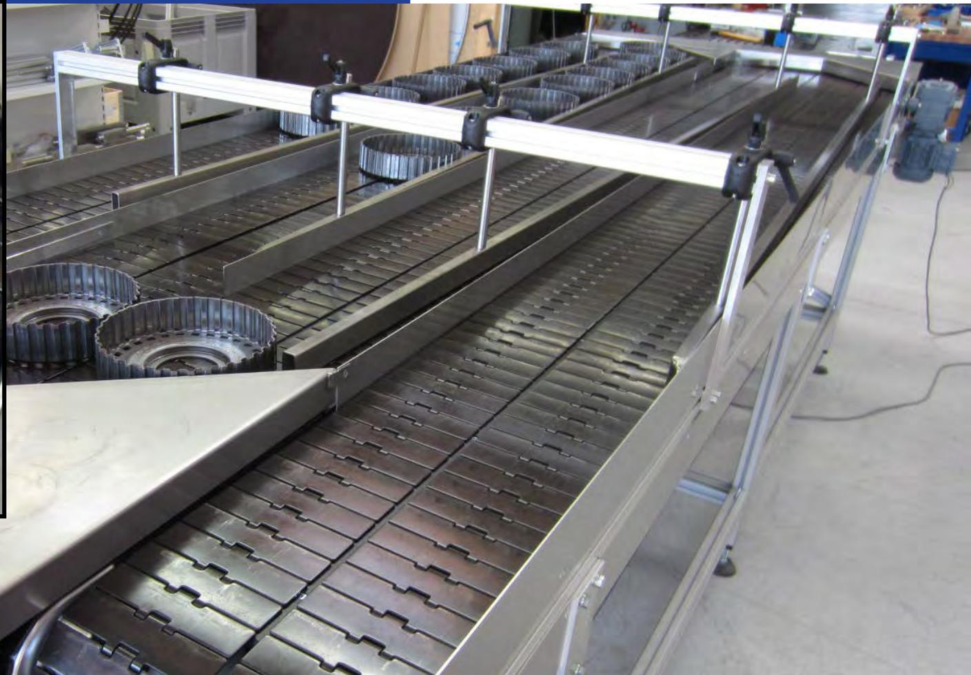
Pufferspeicher für Getriebebeschalen
